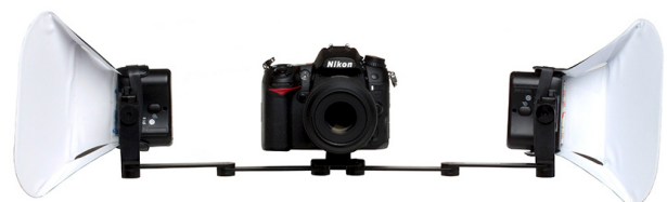
Figura 9. Flashes independientes conectados a la cámara mediante un brazo articulado. Además, en los flashes se han colocado unos difusores tipo "Bouncer" (lumiquest p.e.) para que la luz rebote sobre ellos y esta sea más suave cuando incida sobre el objeto que se fotografía.
